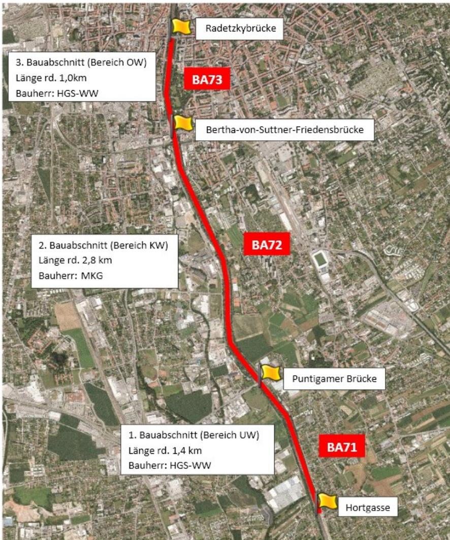
Abbildung: Lageplan ZSK – BA72, 1. bis 3. Bauabschnitt
